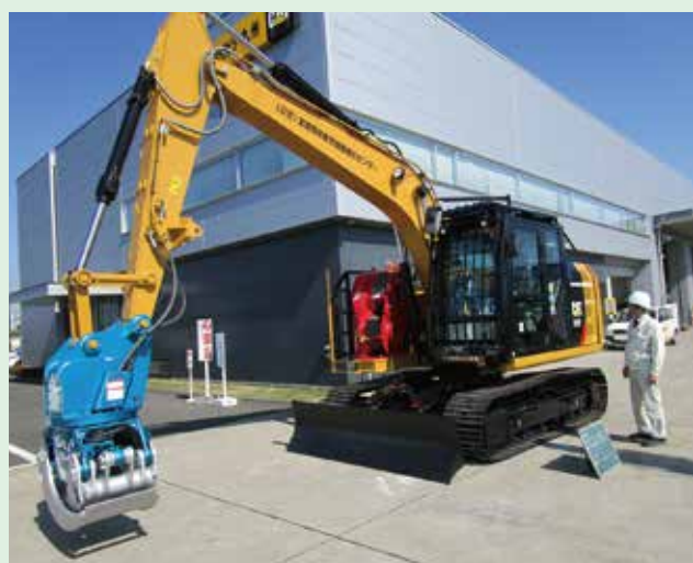
令和元年度導入のスイングヤーダ (CAT312F、イワフジSW302)
