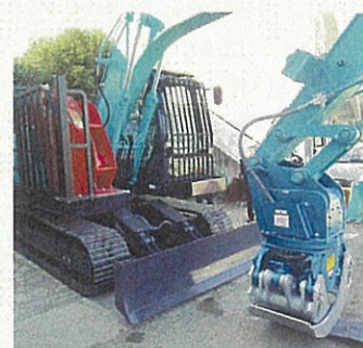
令和7年度導入のスイングヤーダ （コベルコSK130-11、イワフジSW302）
